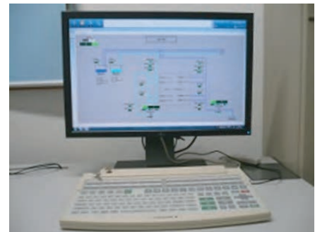
Trạm giao diện tương tác giữa con người và máy móc với bàn phím chuyên dụng.
