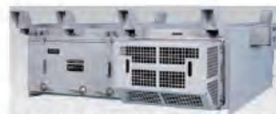
Dispositivo de inversor s para vagones ferroviarios con aplicación de SiC
