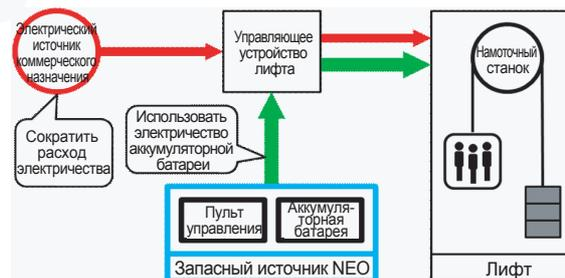
Рис.4: Запасный источник NEO (Энергосберегающий тип)
