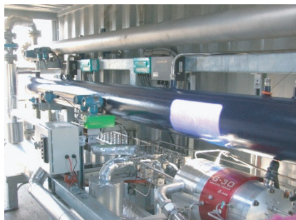
Испытательный стенд теплопередачи GRANEX®
