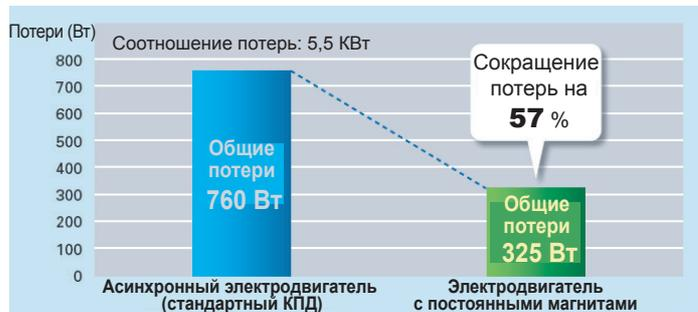
Сравнение потерь для асинхронных электродвигателей и для электродвигателя с постоянными магнитами
