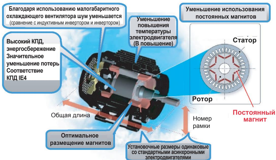
Конструкция электродвигателя с постоянными магнитами
