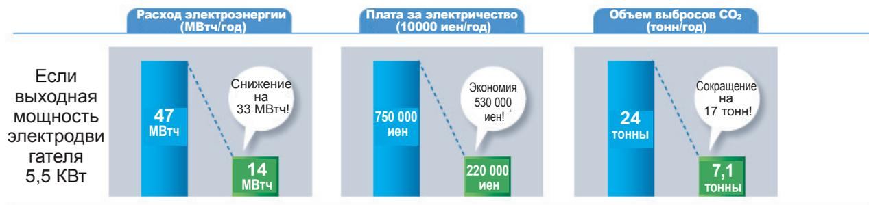
Пример результата энергосбережения (в случае замены асинхронных электродвигателей на электродвигатель с постоянными магнитами)
