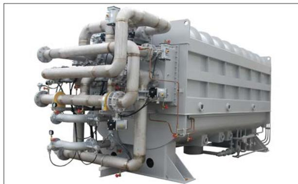
Внутри вакуумного контейнера находятся адсорбенты и вода. Холод генерируется чередованием процессов десорбции и адсорбции в условиях вакуума.
