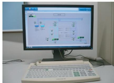
Станция с человеко-машинным интерфейсом и со специализированной клавиатурой.
