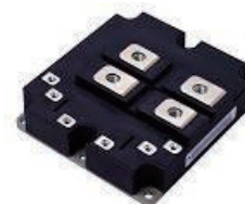
Силовой модуль из карбида кремния (1700в/1200а×2 элемента)
