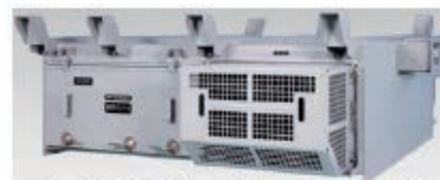
Инверторное устройство из карбида кремния для железнодорожных вагонов
