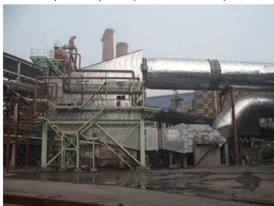
Usina de recuperação do calor de exaustão para o refrigerador de sinterização (Wuhan Steel, China)
