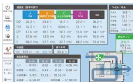
● エネルギー削減率の表示 (リアルタイム)
