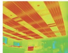
\* 放射パネルは、湾曲による放射面積の拡張とスリットによる自然対流の促進により、一般的な放射パネル製品より、約130%冷房能力が高く、敷設面積を最小とすることが可能である。
