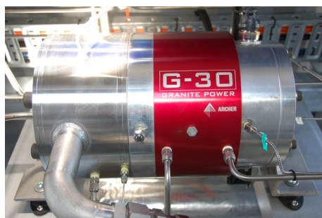
ターボ発電機
