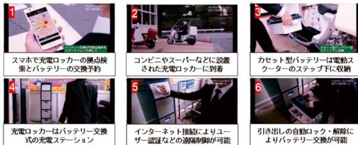
図3：電動スクーター用バッテリーシェアリングのサービス提供工程
